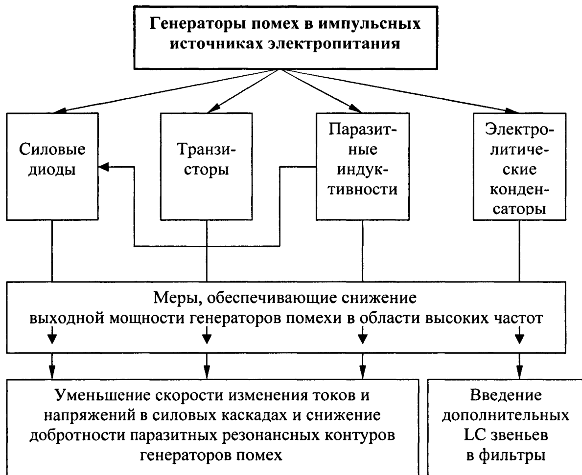
Рисунок 4.1 - Структурная схема функциональных генераторов помехи, и основных путей снижения уровня помех.
